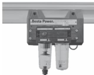
Filtre et lubrificateur à brouillard
