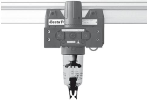
Le chariot de prélèvement 1/2" est utilisé lorsque le débit volumique requis ne peut plus être fourni de manière économique par le chariot 3/8". Le chariot 1/2" doit être équipé d'une unité FRL pour être opérationnel. Le chariot peut être utilisé dans une plage de pression comprise entre 2 et 10 bar et est économique jusqu'à un débit volumique d'environ 1500 NI/min., max. env. 2000 NI/min.
