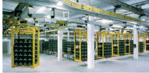
Gamme SingleFlexLine 0811 installé sur une convoyeur aérien
