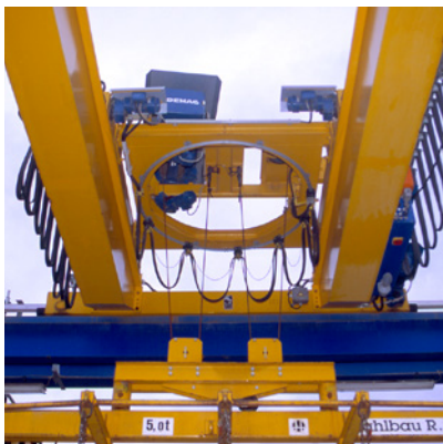
Alimentation du palan rotatif sur un pont roulant
