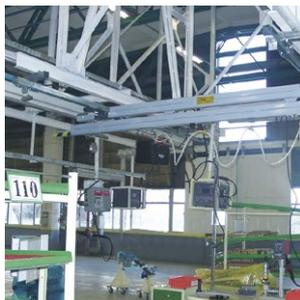
**Poutre porte équipement pour appareils** d'une ligne de montage
